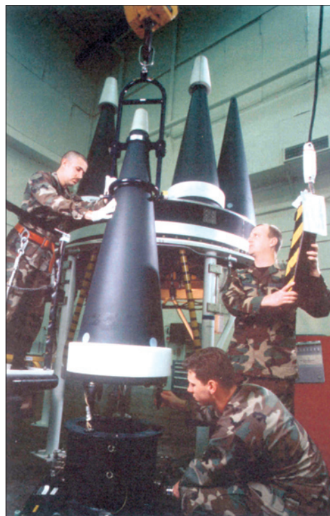
Снятие боевых блоков типа Mk 21 с платформы разведения головной части МБР МХ
