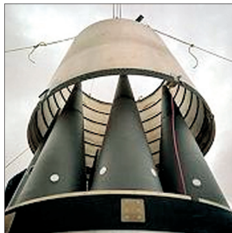
Установка нижней секции головного обтекателя головной части МБР
