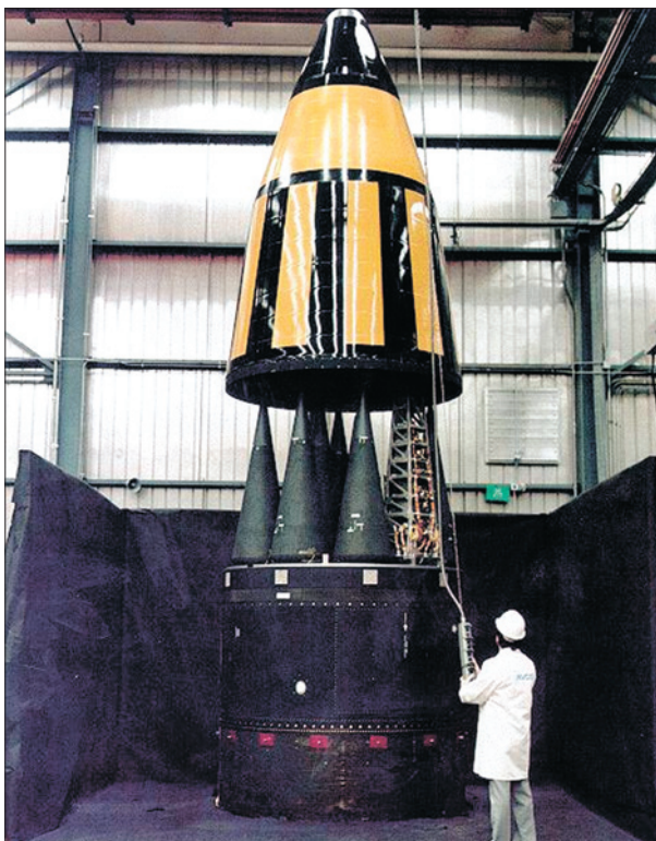
Разделяющаяся головная часть с боевыми блоками индивидуального наведения
