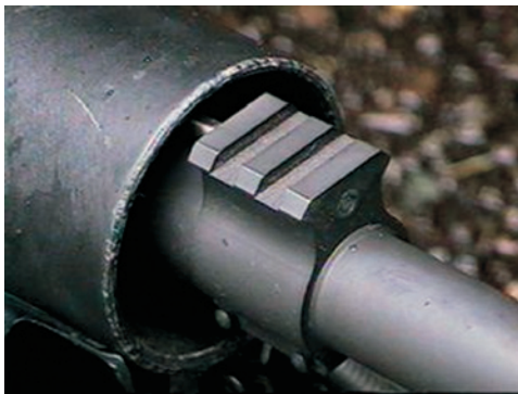
Рис. 11. Вид на узел газоотвода с направляющей рельсового типа и цевье SR-25 Match
